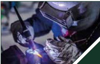
Tig kaynağı Tig welding
